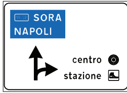
Fig. 233 segnale di preavviso di intersezione urbana
